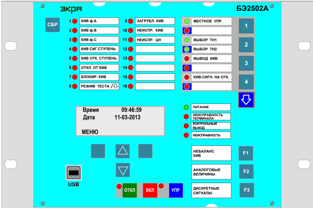
Рисунок 38 - Расположение элементов на лицевой панели терминала БЭ2502А1401
